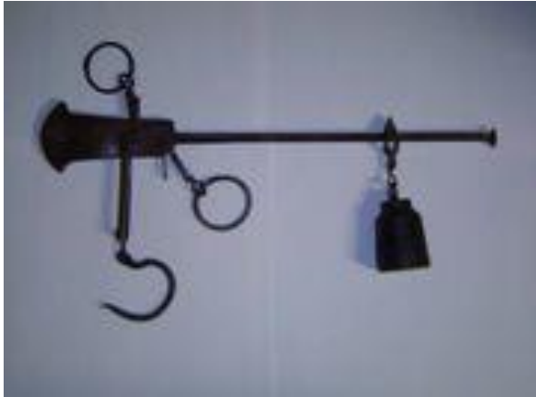
La balance romaine est utilisée par les bouchers
